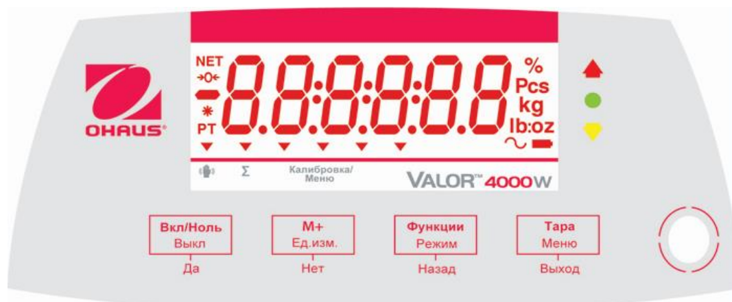
Рис. 3-1. Передняя панель весов Valor 4000W со светодиодным дисплеем
