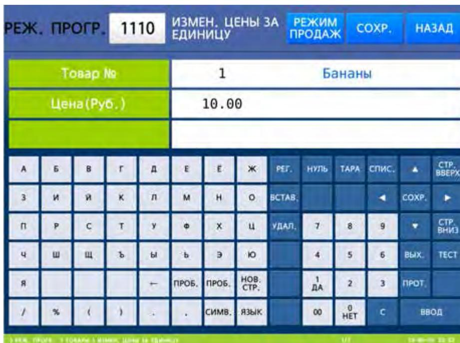
Рисунок 1.4 – Вид дисплея весов CL7000-S в режиме программирования при активной функциональной клавиатуре
