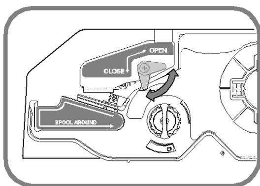
Рисунок 1.19 – Управление прижимным рычагом головки принтера
