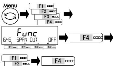
Нажмите клавишу [Menu], затем используйте клавиши [F1-F4] для выбора опции <645 SPAN OUT>. Нажмите клавишу [F4] для подтверждения. Используйте клавиши [F1/F2] для выбора.
