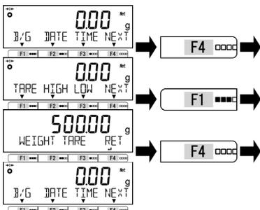
Масса тары может быть отображена нажатием функциональной клавиши, если такая функция для клавиши была запрограммирована. См раздел 8 "Функции управления".
