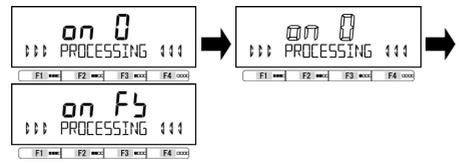
На дисплее отображается процесс установки нуля. Мигающая надпись <on 0>. По завершении появится индикация <on FS>.
