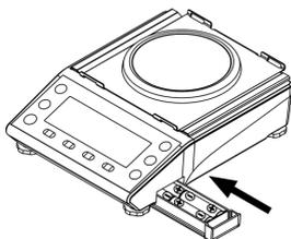
Когда весы питаются от батарей, отображается индикатор, "▢▣▢". Он изменяется в зависимости от состояния батарей.
