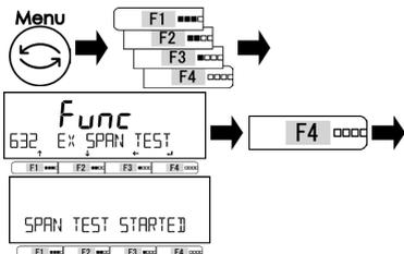
Нажмите клавишу [Menu], затем используйте клавиши [F1-F4] для выбора опции <632 EX SPAN TEST>. Нажмите клавишу [F4] для выполнения.
