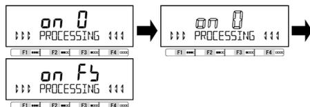
На дисплее отображается процесс установки значения нуля. Мигающая надпись <on 0>. По окончании отобразится сообщение <on FS>.
