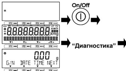
Подключите адаптер питания к весам. Когда адаптер подключен, весы перейдут в спящий режим, на экране появится значок звёздочки < \* >.
