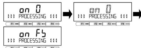
На дисплее отобразится процесс установки значения нуля. Мигающая надпись <on 0>.
