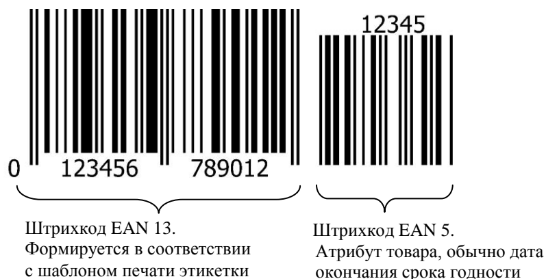
Рис. 6.2 – Структура штрихкода EAN 13+5
