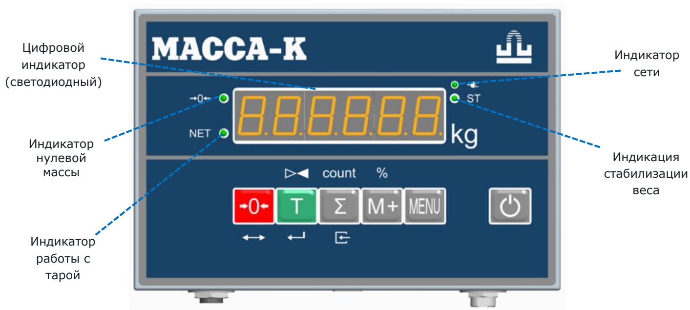
Передняя панель терминалов АВ и АВ(RUEW)
