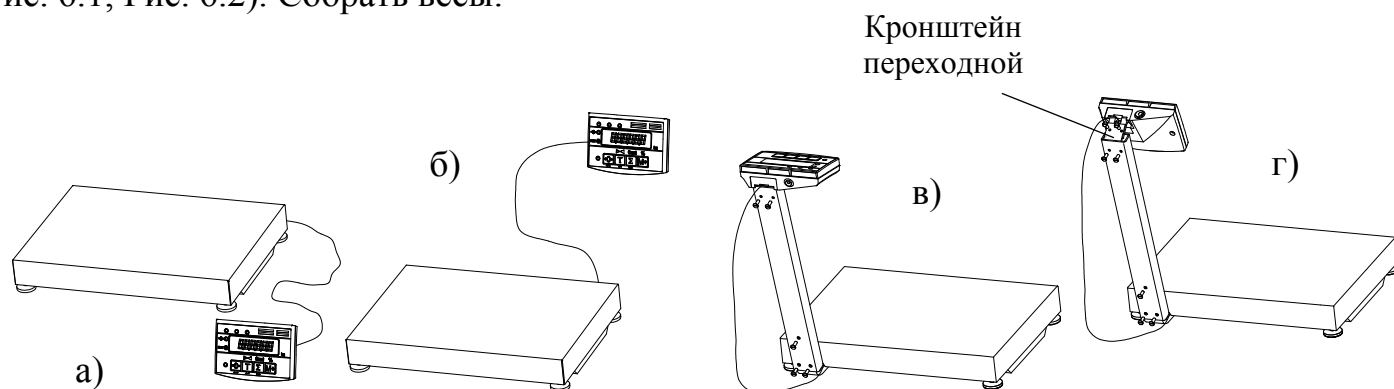
Рис. 6.1 - Варианты размещения устройства управления: на столе (а); на стене (б); на стойке в горизонтальном положении (в); на стене в вертикальном положении (г);
